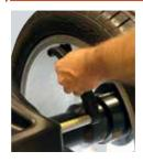
Измерение эксцентричности используя устроиство измерения растояния.
