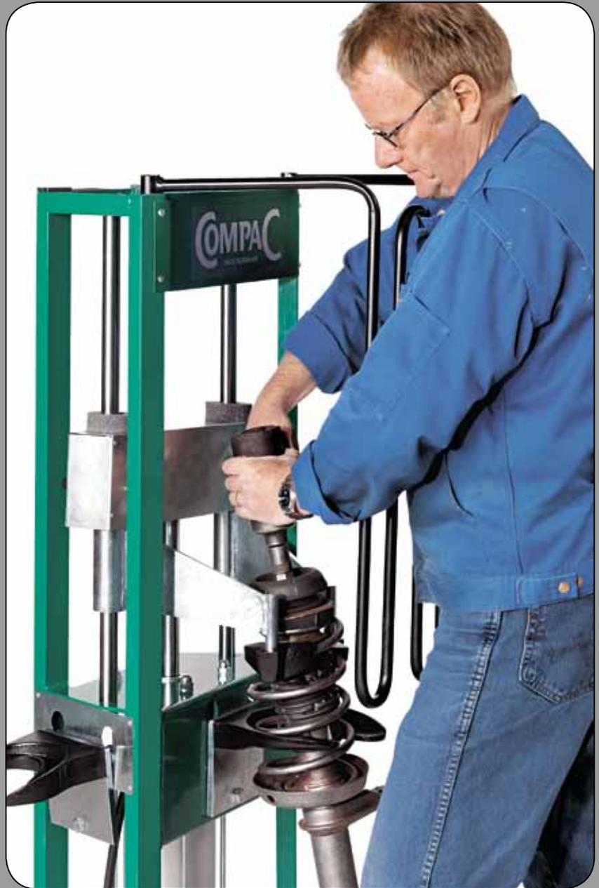
Легкий доступ для монтажа и демонтажа верхней гайки.
