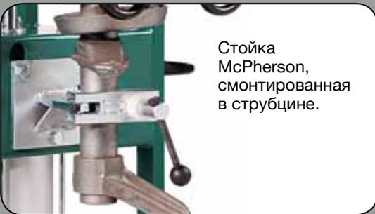
Стойка McPherson, смонтированная в струбцине.
