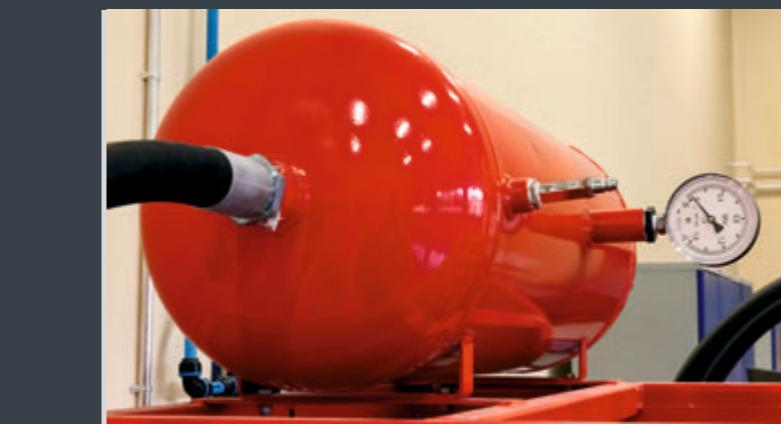
Для облегчения работы оператора клеть оснащена ресивером, который позволяет осуществить посадку шины бескамерного колеса на диск для последующего его накачивания.
