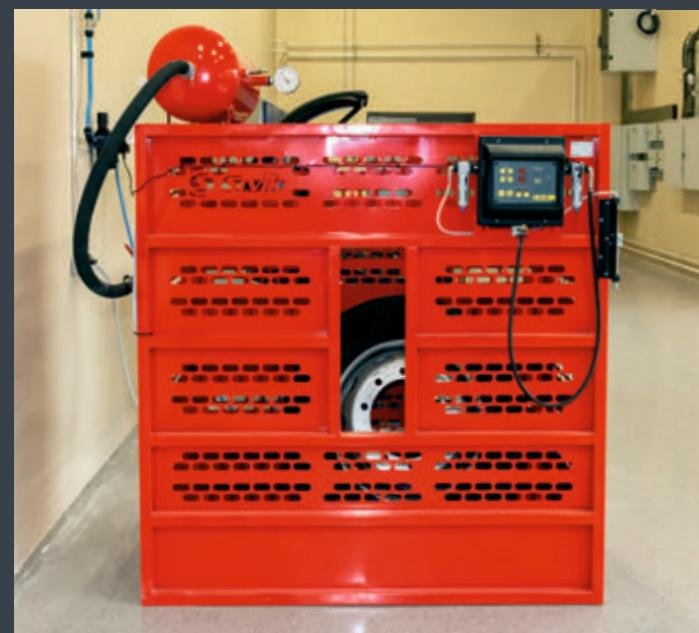
Клеть для накачки колёс автобуса, троллейбуса, электробуса предназначена для обеспечения безопасности оператора при накачивании колёс транспортного средства.
