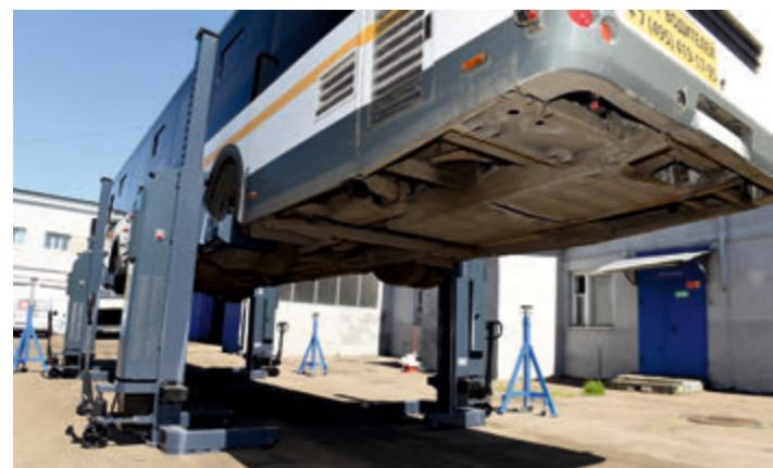
**Возможность одновременной работы с несколькими автобусами.** Преимущество подкатных подъемников состоит в том, что при использовании дополнительных опорных стоек можно обслуживать несколько автобусов одновременно. Комплект подъемников необходим непосредственно для подъема или опускания ТС.
