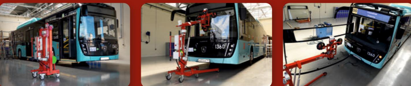
Устройство предназначено для демонтажа, примерки и установки лобовых стёкол на автобусах, трамваях, троллейбусах, электробусах и грузовых автомобилях.
